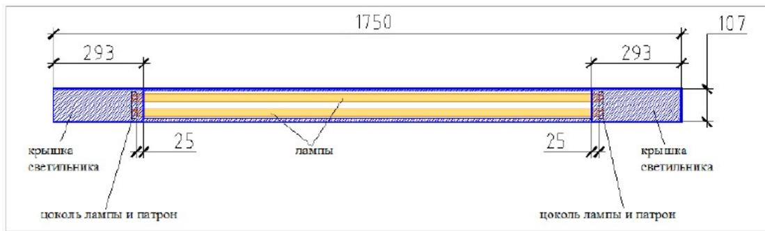
**Описание:** подвесной модульный симметричный светильник из алюминиевого профиля под две светодиодные лампы-трубки, оснащен встроенной 4-жильной (4C) или 5-жильной (5C) магистральной электропроводкой и алюминиевым рефлектором, рефлектор может быть во всю длину лампы или более короткий (прим. по 100мм от краев).
